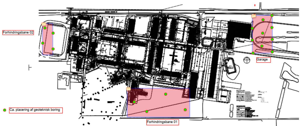
Figur 1. Placering af garageanlæg og forhindringsbaner på kaserneområdet.
